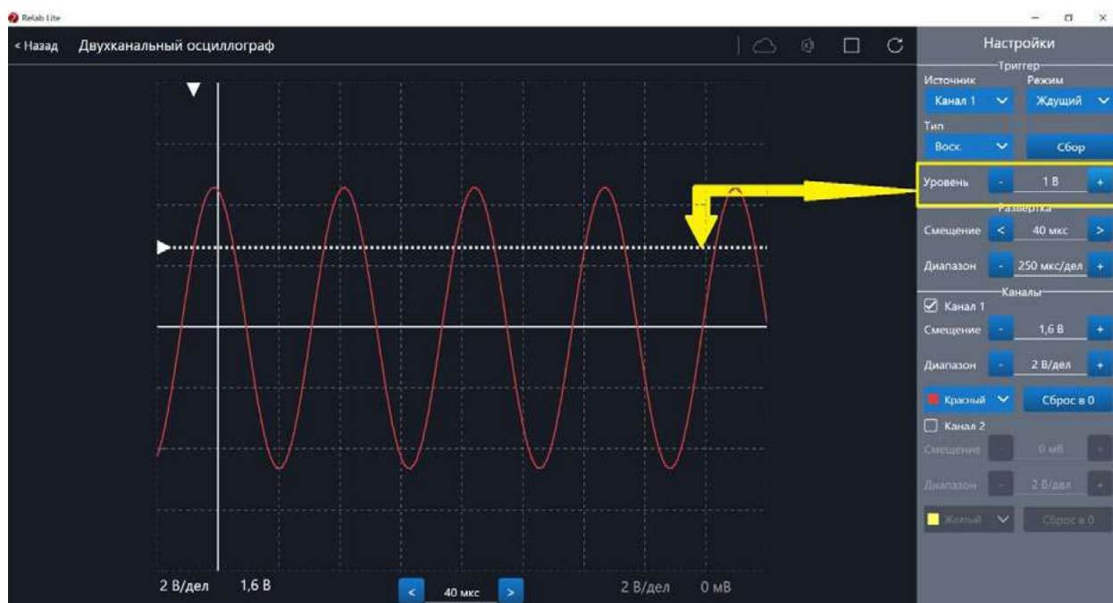
Рис. 37. Использование блока настройки Уровень
