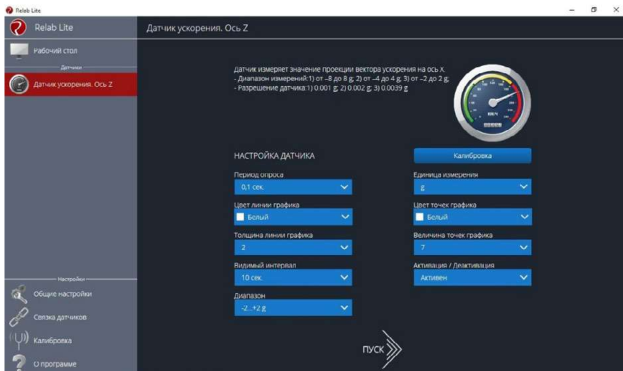
Рис. 2. Изменение параметров сбора данных
